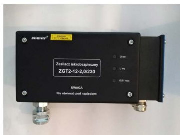
Rys. 8. Kasetka koncentratora LKP w obudowie pyłoszczelnej oraz jej zasilacz
