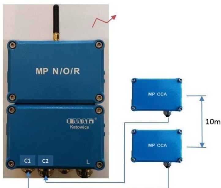
Rys. 7. Moduł koordynatora transmisji radiowej MP N/O/R z podłączonymi dwoma modułami pomiaru ciśnienia atmosferycznego CCA
